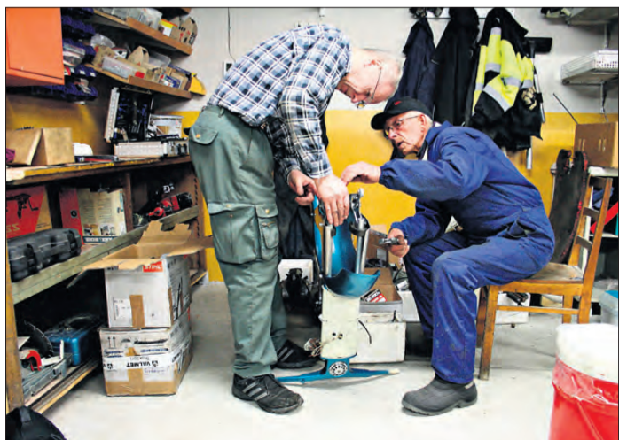
Kursledaren Harry Österman och Bertel Kullas försöker klura ut vad det är för fel på fjädningen i den här nedmonterade Monarken av 1959-års modell.
