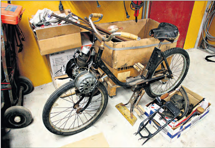
Den fransktillverkade Velosolexen är en mycket tidig mopedmodell. Motorn är en tvåtaktare på 0,6 hästkrafter. Mopeden rullar, även om alla delar ännu inte är på plats.
